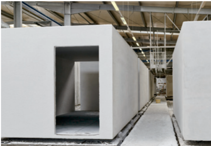
Die Endmontage des Rohlings beginnt mit einer sorgfältigen Bearbeitung der Innen- und Außenflächen.
